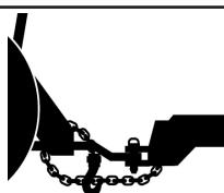
Ao acoplar o equipamento ao trator, utilize uma corrente para travar o cabeçalho do equipamento à barra de engate do trator. Esta medida evitárá que as mangueiras hidráulicas venham a se romper ou o equipamento venha a empinar em caso de quebra do sistema de engate.
